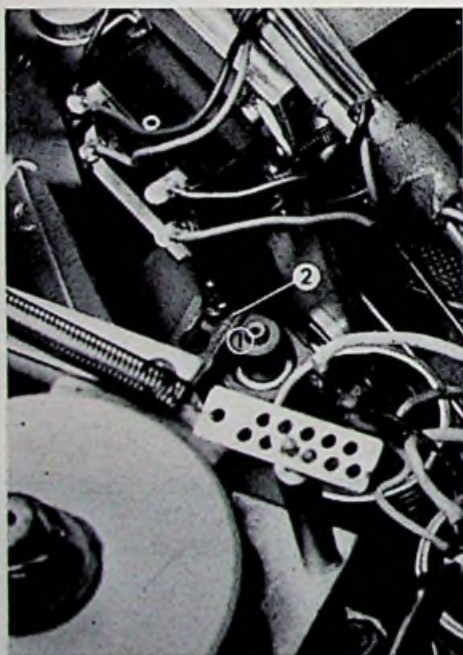
Afb. 7 - De bandspanningsregeling aan de onderzijde van het deck.
